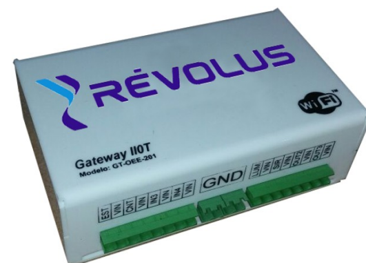
Gateway IIoT GT-OEE-201 · bornes plugáveis · Wi-Fi 2,4 GHz
